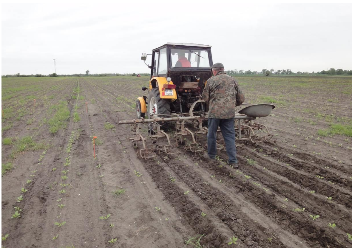
Fot. 2. Pielnik tradycyjny ze sterowaniem ręcznym; Sokolniki k. Kruszwicy 2023
