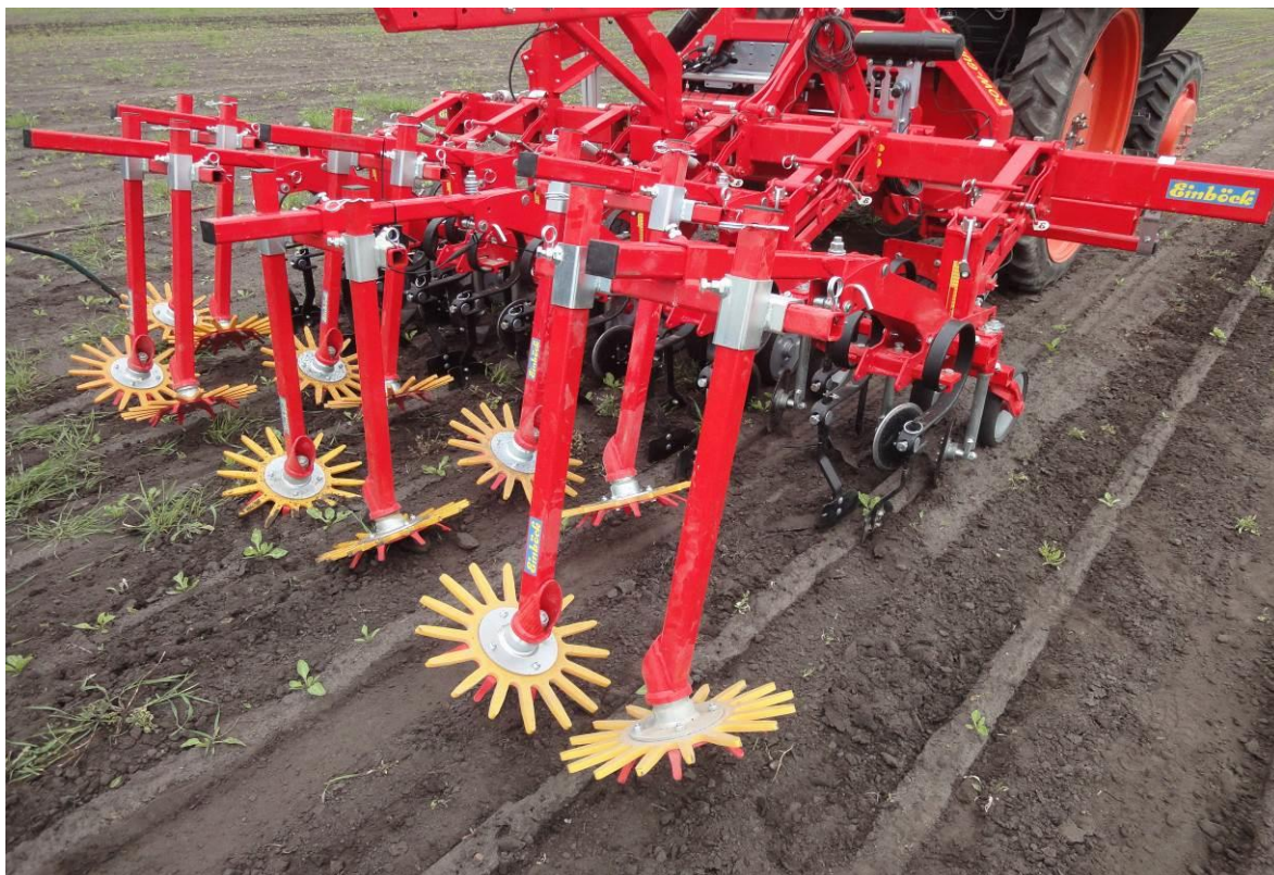
Fot. 1. Pielnik precyzyjny ze sterowaniem optycznym; Sokolniki k. Kruszwicy 2023
